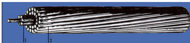
Obrázek 5.1: Konstrukce kombinovaného lana 1 - ocelová duše, 2 - hliníkový plášť
